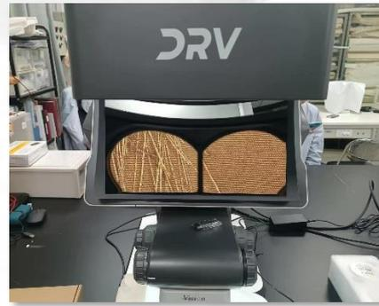
无目镜体视显微镜采用独家专利设计，修复师在观察目标物时，无需双眼精准紧盯“目镜”，可保持舒适坐姿，肩颈自然放松，头部也能自由移动，减少颈部背部劳损，即使长期工作也能保持舒适度，不易产生眼疲劳，并且不影响修复师配戴眼镜或护目镜。眼睛和身体疲劳程度都减至最低，确保修复师在工作中更舒适、更高效，最终实现在显微镜下修复的功能。
